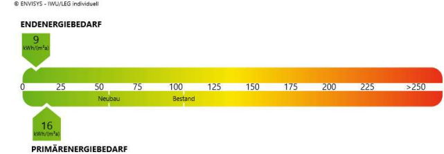
... nach Vollsanierung (L/W-Wärmepumpe + PV)
